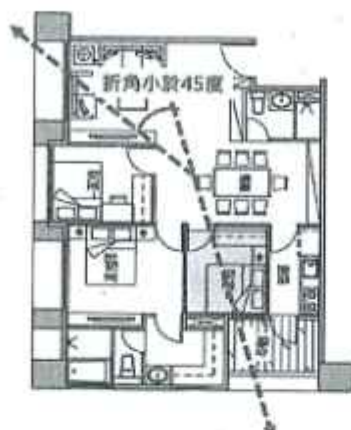
圖 3 臥室三打開門後可形成由其開窗連結客廳開窗的對流通風路徑，可被認定為單雙向開窗通風房間
